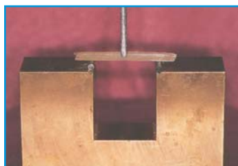
Рис. 2. При нагрузках на изгиб, волокна работают на растяжение
